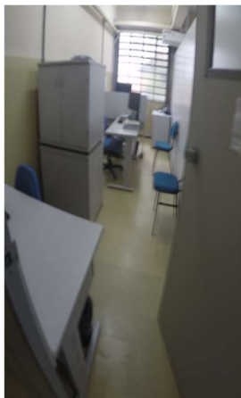
Imagem 20 – Gabinete 03 localizado na sala A-207 com atendimento ao público sem circulação que permita giro de 180° á P.C.R, e sem mesa acessível facilmente identificada.
