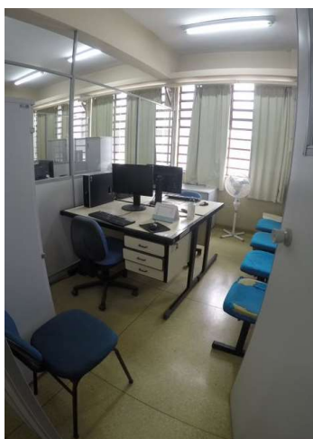
Imagem 23 - Ambiente Sala E 206 não possui mesa acessível para atendimento ao público, não possui espaço para manobra de P.C.R.
