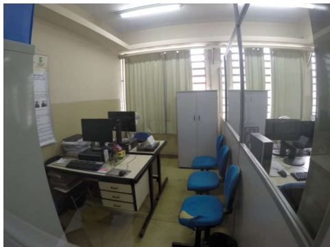
Imagem 19 – Ambiente Sala E 206 não possui mesa acessível para atendimento ao público, não possui espaço para manobra de P.C.R.
