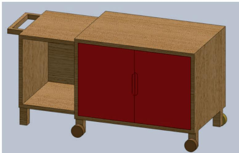
**Figura 10.** Proposta de Rack. Móvel extensível para diversos ambientes de fácil movimentação
