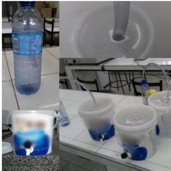
**Figura 1. Materiais utilizados na construção dos fermentadores.**
