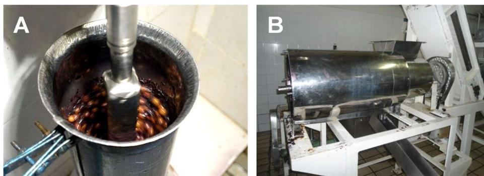
**Figura 2:** Processamento industrial de juçara; A – Despulpadora elétrica vertical de açai; B – Extrator industrial para frutos tropicais.
