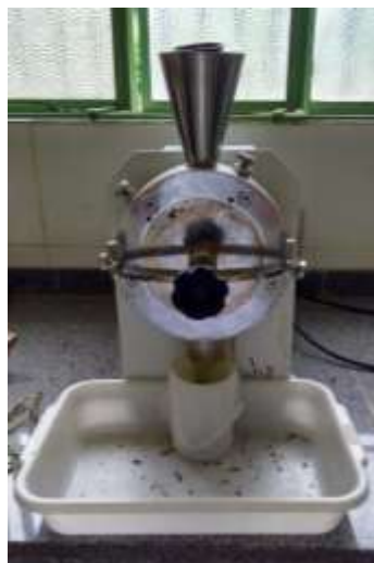
Figura 2 - Triturador do tipo moinho de faca triturando folhas de M. azedarach secas.
