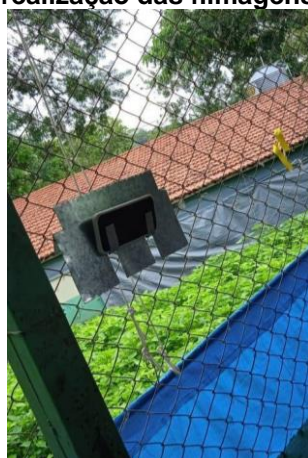
Figura 5 - Estrutura utilizada para a adaptação dos smartphones à tela do galpão para realização das filmagens.
