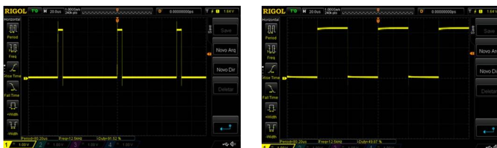
Figura 3: Forma de onda para dois valores distintos lidos no ADC.
