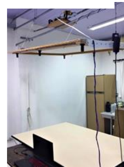
Mesa automatizada com o braço robótico (no topo) e a estrutura suspensa (verticalmente variável).
