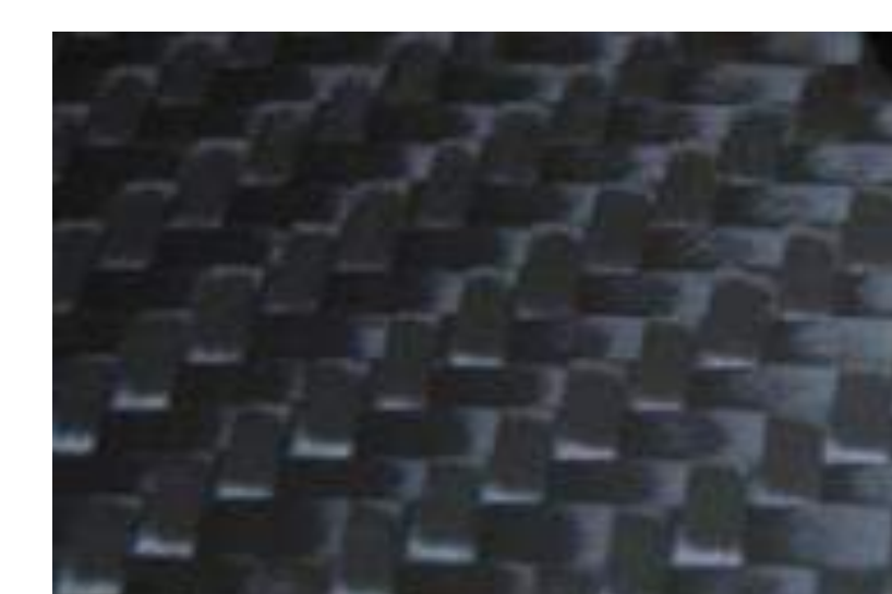
Laminação híbrida com Tecido de fibra de carbono.
