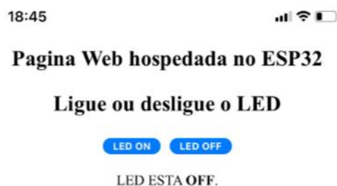
Figura 1 - Página Web que permite de forma remota acionar um led conectado ao ESP.
