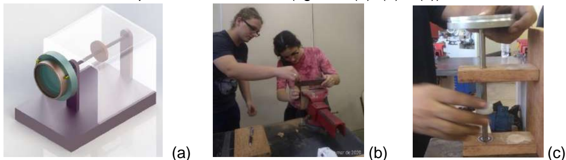
Figura 1 (a) Design modelo 3D; (b) corte das madeiras; (c) montagem.
